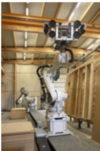
Les robots utilisés par A2C et iMax Pro sont de marques ABB, leader mondial dans le milieu de l'automobile notamment. Puissants, rapides, précis et très fiables, ils sont capables d'effectuer de nombreuses opérations grâce à une multitude d'outils interchangeables.
